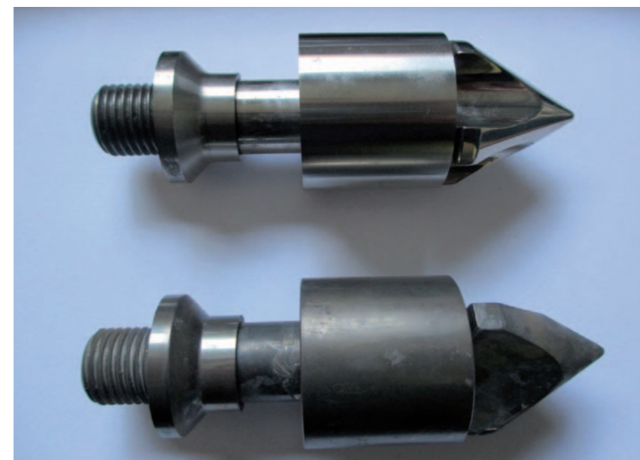
Bilder der Rückstromsperre nach 5000 Zyklen im Test. Oben mit Technyl® One, unten mit einem Standard Polyphthalamid (PPA)
